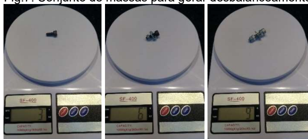
Fig.7. Conjunto de massas para gerar desbalanceamento
